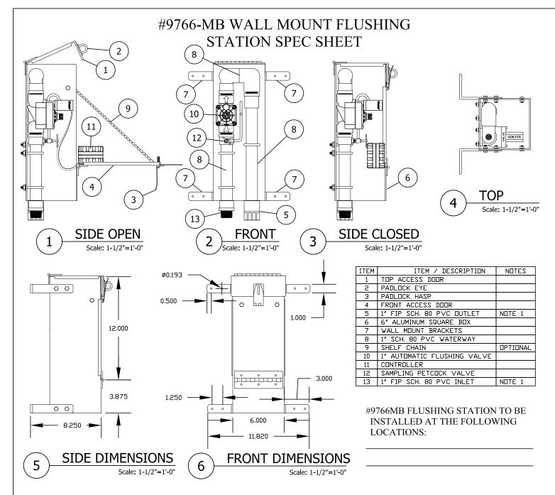
FLUSHING STATION SHALL BE ENCLOSED IN A LOCKABLE, NON-REMOVABLE 6" SQUARE ALUMINUM BOX WITH HINGED OPENINGS.
